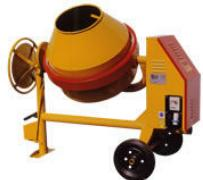
Macchina per la produzione di malte e calcestruzzi, composta da una tazza che accoglie al suo interno i componenti dell'impasto, con specifici raggi per la miscelazione. L'operazione di impasto avviene per rotazione della macchina o per rotazione dei raggi, in movimento rispetto alla macchina.
