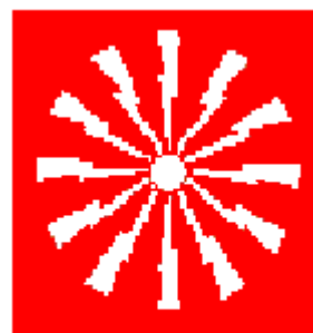
PULSANTE DI ALLARME ANTINCENDIO
