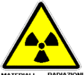
MATERIALI RADIOATTIVI O RADIAZIONI IONIZZANTI
