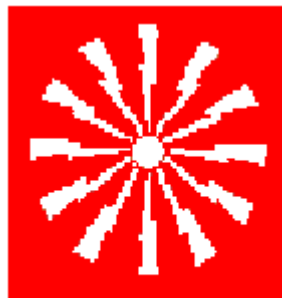
PULSANTE DI ALLARME ANTINCENDIO
